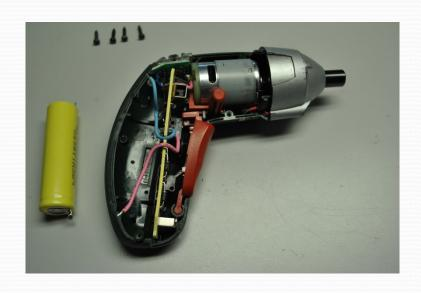
Schritt 6: Die abgelötete Zelle aus dem Gerät entfernen.
